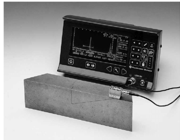
Kuva 55 USN50: Luotaus MWB60-4E kulmaluotaimella
