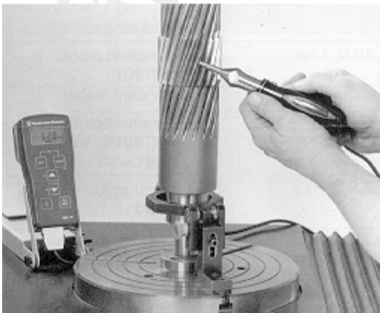
Fig. 1: Vetoakselin hampaan kyljen kovuusmittaus UCI-laitteella.
