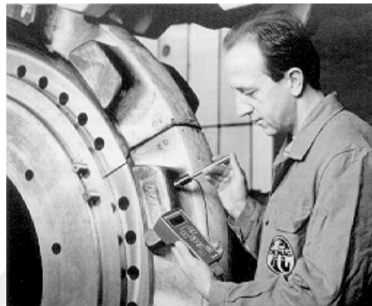
Fig. 2: Suuren hydraulisen kaivinkoneen vetopyörän kovuusmittaus käyttäen kimmahdusmittaria.
